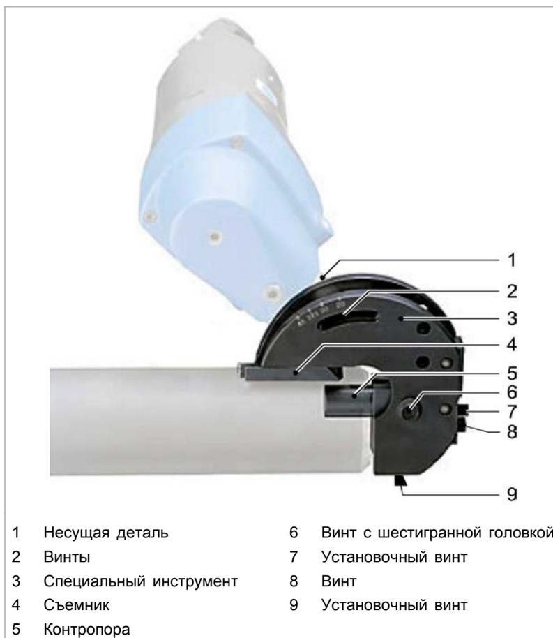
Для внутреннего диаметра трубы 30-120 мм
