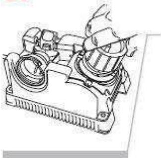
**Осуществите выравнивание сверла, затяните патрон и заточите, как обычно**
