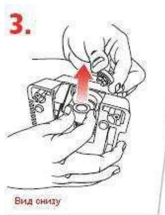
Снимите шлифовальный круг, замените его, и затяните быстросъемный маховик, повернув его против часовой стрелки, пока шлифовальный круг не будет удерживаться от прокручивания.
