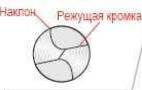
Если внимательно рассмотреть хорошо заточенное сверло, то видно, что поверхность от режущей кромки вниз по наклону до самой нижней точки хорошо шлифованная без углублений и других изъянов. И режущая кромка всегда выше нижней точки наклона.
