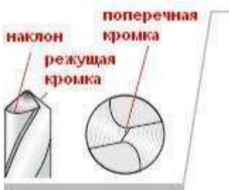
Поверхность от режущей кромки вниз по наклону до самой нижней точки хорошо шлифованная без углублений и других изъянов. Режущая кромка всегда выше нижней точки наклона. Поперечная кромка четкая и прямая.
