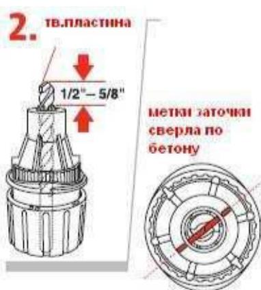
**Выровните сверло по меткам заточки сверл по бетону**
