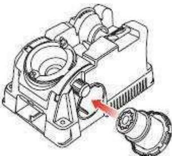
Трубка для абразивной пыли разработана, чтобы удерживать искры, возникающие при заточке внутри станка, тем самым защищая пользователя. В дополнение трубка уменьшает попадание абразивной пыли в воздух и на рабочий стол.
